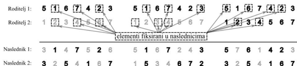
Slika 3: Primeri razdvojenih ordered ukrštanja. a) sa istim brojem i lokacijama fiksniranih elemenata; b) sa istim brojem i različitim lokacijama; c) sa različitim brojem fiksniranih elemenata
