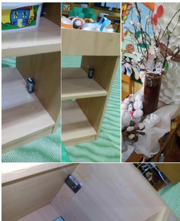
Слика 1: Положаји сензора (у смјеру казаљке на сату) за мјерење температуре ваздуха на висинама од 10, 40, 65 и 110 cm.
