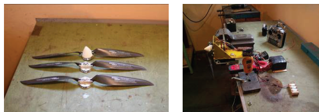
Слика 6: Испитивање статичке вучне силе - склоп мотор - елиса (двокрака, склапајућа)
