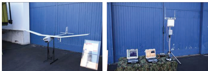
Слика 1. Разматрана електрична беспилотна летелица (маса m=8.5 kg, размах крила b=2.8 m, дужина летелице L=1.94 m, висина H=0.47 m, површина крила S=0.75 m 2 , маса "корисног" терета 1.5 kg) са земаљском станицом
